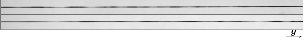
FIGURE 3.20 – Deux photographies laissant apparaître les modulations de type Plateau-Rayleigh (Jet de billes de 40 \mu\text{m} (haut) et de 10 \mu\text{m} (bas) en suspension dans un liquide de viscosité 0.13 Pa \cdot s).
